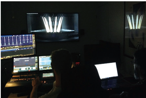
GrandMAのヴィジュアルライザーで打ち込み/キッカケ確認
